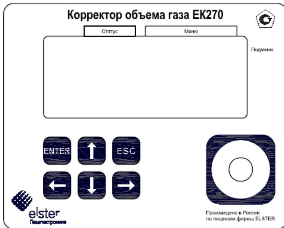
Рис.1. Внешний вид корректора EK270
